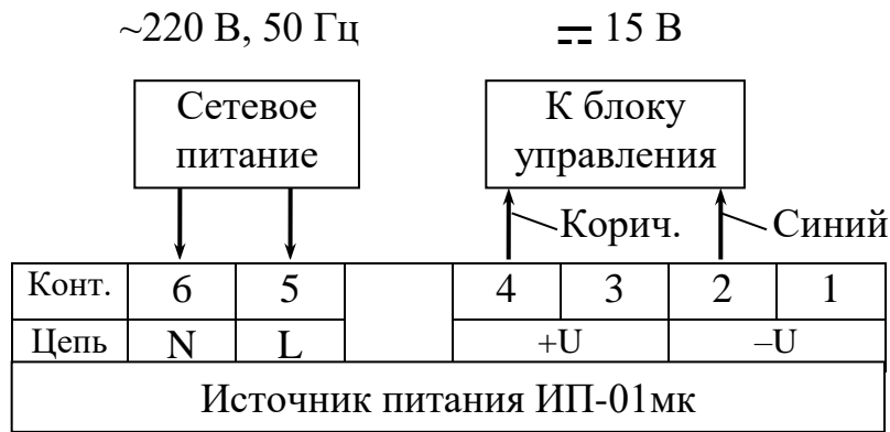
Рисунок 2.14 – Схема подсоединения кабелей к источнику питания ИП-01мк
